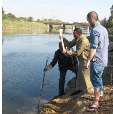
**Abb. 3:** Einschlagen einer Sonde zur Wasserprobenahme unterhalb einer Kanalsohle in Ägypten
