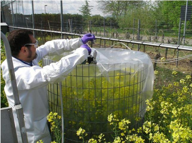
Vorbereitungen zur Applikation eines Lysimeterversuches mit Rapspflanzen
