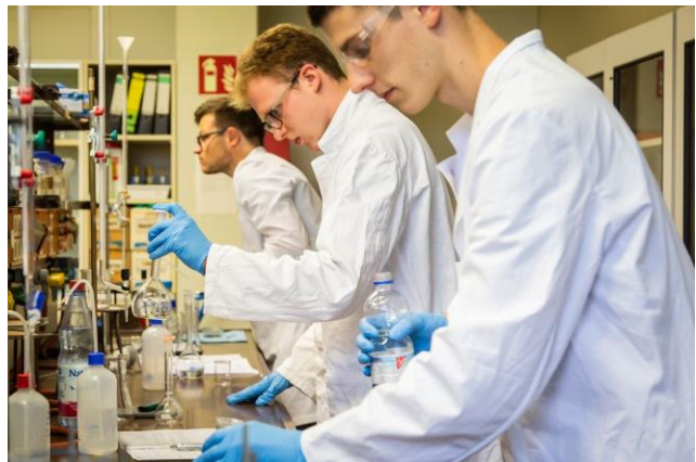
Abb. 2 Studierende des Offenburger Bachelorstudienganges Umwelttechnologie bestimmen komplexometrisch die Wasserhärte eigener Proben
