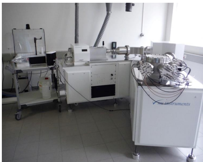
Abb.1: Multi Collector ICP-MS Labor am Helmholtz Zentrum Geesthacht zur Nutzung nichttraditioneller stabiler Isotopensysteme für die Untersuchung von Vorkommen, Transport und Verbleib von anorganischen Schadstoffen (©HZG)
