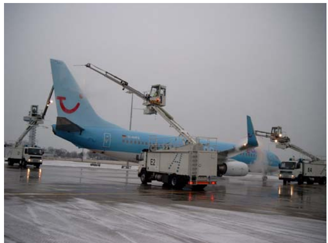
Abb. 1. Flugzeugenteisung am Flughafen Hannover-Langenhagen (Foto: Flughafen Hannover-Langenhagen GmbH)
