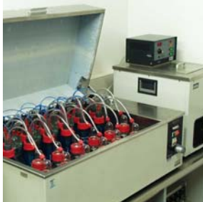
Abbildung 1 a: Messgerät zur Bestimmung der leichten biologischen Abbaubarkeit.
