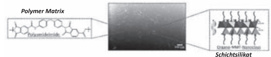
Abb 1: REM-Aufnahme eines mittels FIB preparierten Querschnitts einer PAI Matrix (dunkel) mit exfolierten Schichtsilikaten (weiß)
