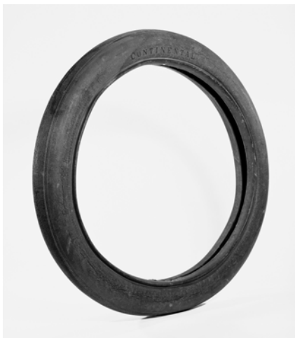
Abb. 5: Einer der ersten Reifen aus Synthesekautschuk (Photo: Deutsches Museum)
