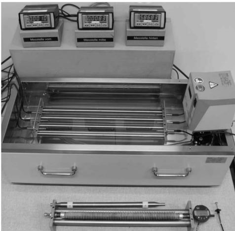
*Vorrichtung zur Messung des autogenen Schwindens*
