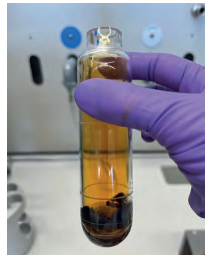
Nur kleine Knopfzellen lassen sich – wegen ihrer geringen Größe – zur Analyse im Spektrometer nach dem Entladen in Säure als Ganze auflösen. Alle anderen Batteriezellen und große Knopfzellen müssen sorgfältig – sprich: aufwendig – zerlegt und zerkleinert werden.
