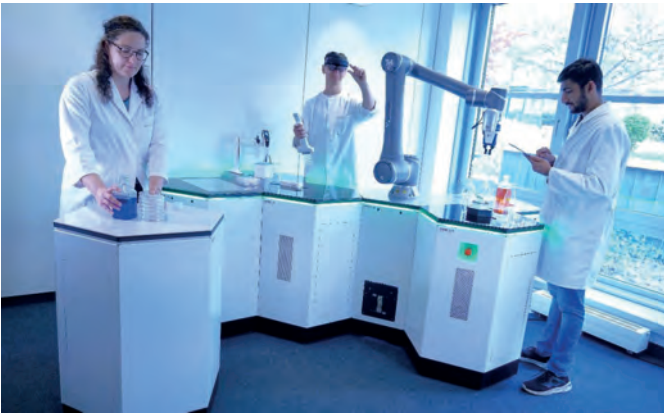
Abb. 2. Beim Laborsystem iHEX von SmartLab Solutions arbeiten Cobots, also kollaborative Roboter, im analytischen Labor gemeinsam mit dem Menschen. (Foto: SmartLab Solutions)
