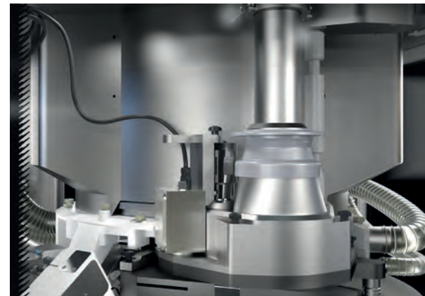
Abb. 1. Tablettierungssystem mit integrierten Nah-Infrarot-Sensoren zur Echtzeitanalyse von mehr als 430 000 Tabletten pro Stunde (Foto: FETTE Compacting)
