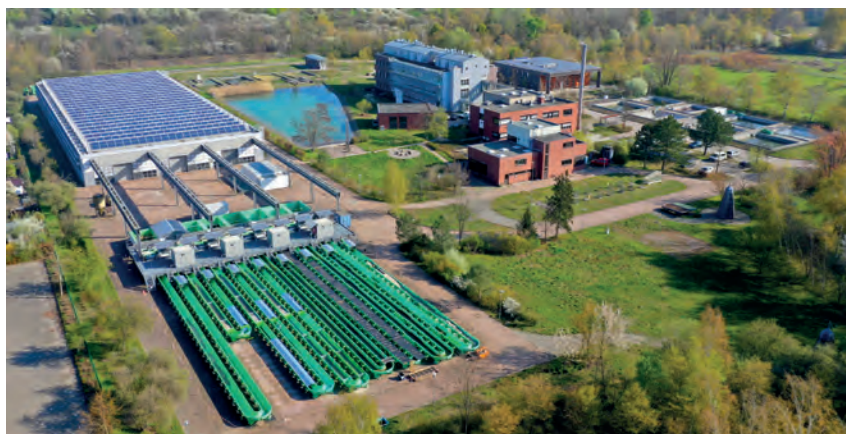
Abb. 1. UBA-Versuchsfeld in Berlin-Marienfelde mit der Fließ- und Stillgewässer-simulationsanlage im Vordergrund (Foto: K. Ruhl)
