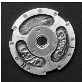
Im Experiment bestrahlte Plutonium-Targets auf dünnen Folien aus Titan. Die auf dem segmentierten Rad montierten drei Folien wurden mit Calcium-Ionen bestrahlt. Deutlich zu erkennen sind die Stellen, an denen die Folien getroffen wurden. (Foto: GSI Helmholtzzentrum für Schwerionenforschung, G. Otto)
