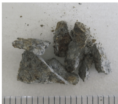
Marsmeteorit KG 002 vor dem Säureaufschluss zur radiochemischen Trennung der Radionuklide ( ^{10}\text{Be} , ^{26}\text{Al} , ^{53}\text{Mn} ...).
